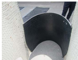
曲げ試験結果 (180度曲げでもクラックなし)
