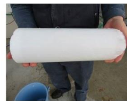
試作機で製造した炭酸氷(氷直径96mm)
