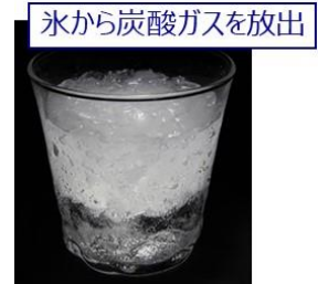
試作機で製造した炭酸氷(氷直径96mm)
